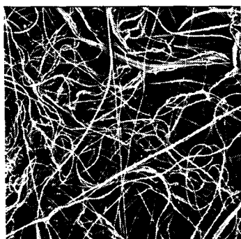
图 3 F8 90%~95% 熔喷聚丙烯细纤维 Ashrae 过滤介质显微镜扫描图像
