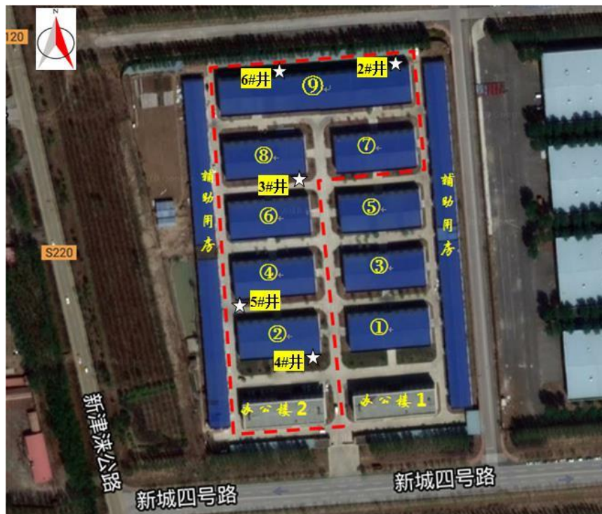
图4.2-3 厂区地下水监测井布点图
