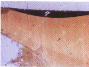
夜盖外面红色部位涂膜断面 50 \mu\text{m} (透过光)
