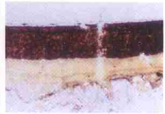
夜盖内面红色部位涂膜断面 25 \mu\text{m} (透过光)
