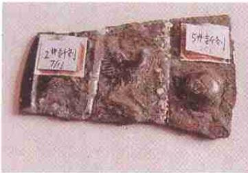
图 7 加湿试验后的 03\* 样品钎缝状况
