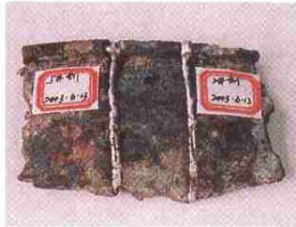
02\* 样品 左侧为 5# 钎剂钎焊接头, 右侧为 2# 钎剂钎焊接头
