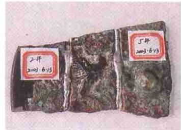
03\* 样品 左侧为 2# 钎剂钎焊接头, 右侧为 5# 钎剂钎焊接头
