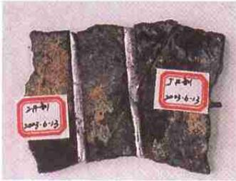
01\* 样品 左侧为 2# 钎剂钎焊接头, 右侧为 5# 钎剂钎焊接头
