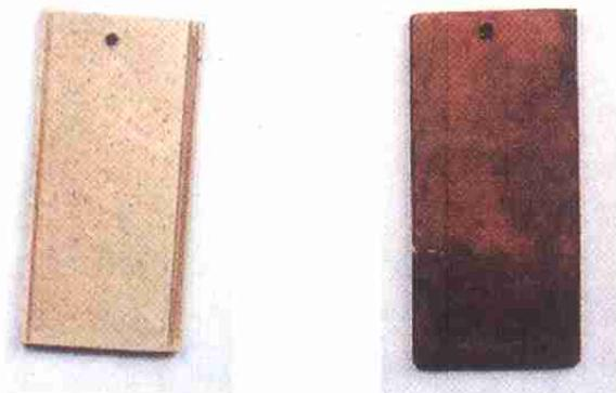
图 4 青铜样品在 2% (左) 和 5% (右) 钎剂中腐蚀试验结果
