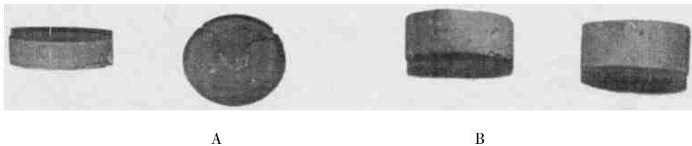
图 11 含 \text{Na}_2\text{SO}_4 样块的裂缝及边缘缺损 A(untreated) B(5%F4-SS)
