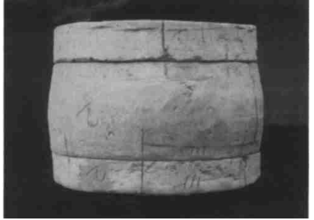
图 8 组装完毕的陶范 包括腹外范 2 块、圈足范 1 块和簋内范 1 块(带芯头)。各范之间都有定位销孔、榫卯、定位线
