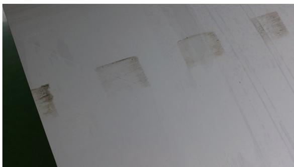
图7 纸卷上的链板擦痕(拖影)
