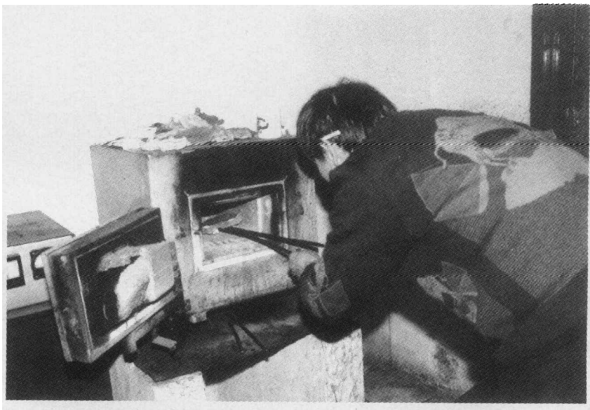
图 6 消除加工硬化的退火热处理
