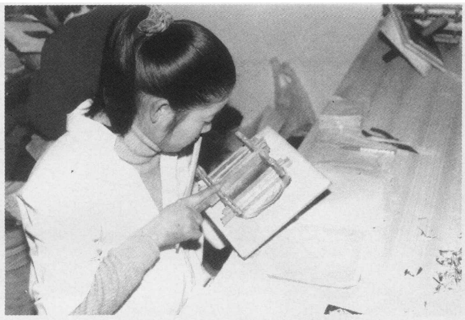
(a) 将金箔从柔软的茅台纸内移到皮板上， 用竹刀切割成所需规格的形状
