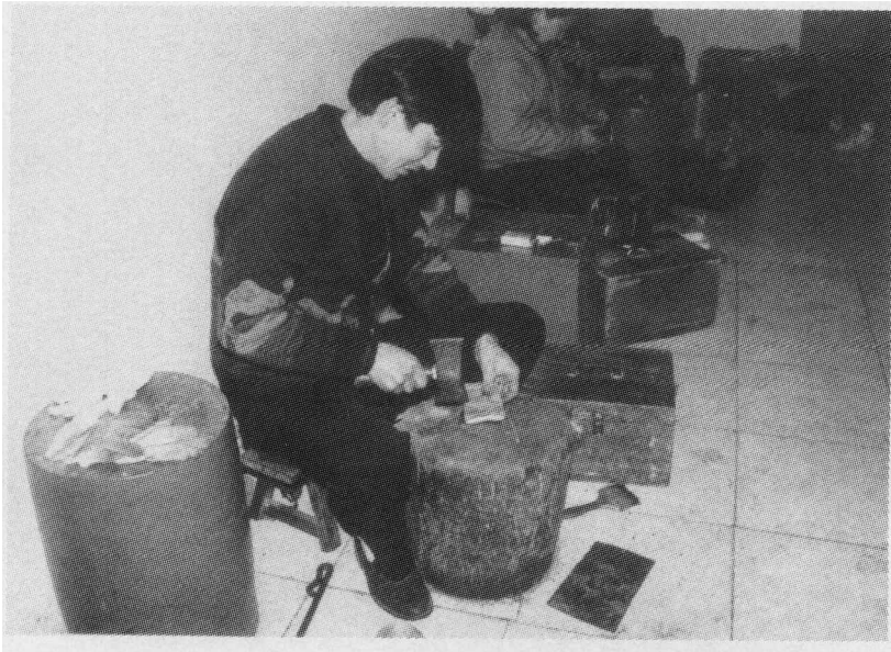
图 5 拍叶:将金块锻打成薄片
