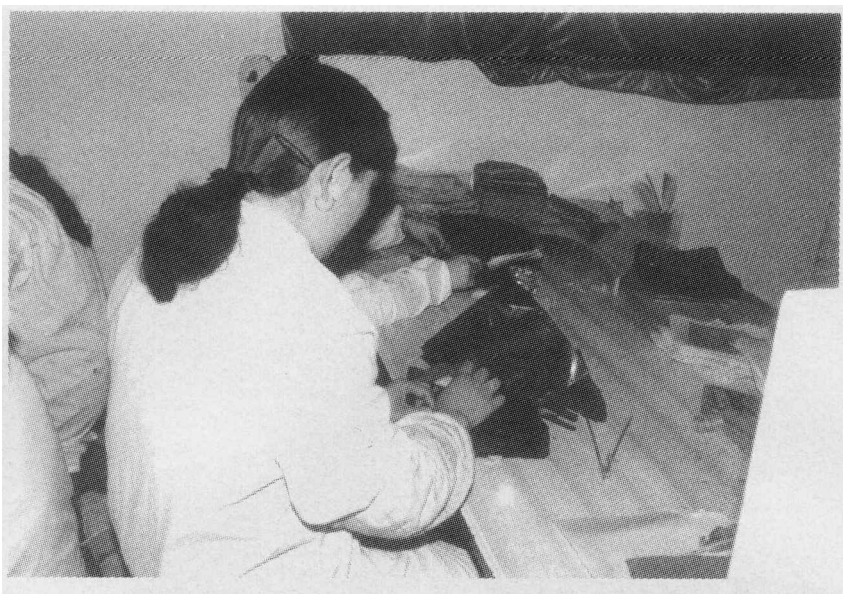
(a) 用布团将每张 20cm × 20cm 的乌金纸均匀扑上一层滑石粉
