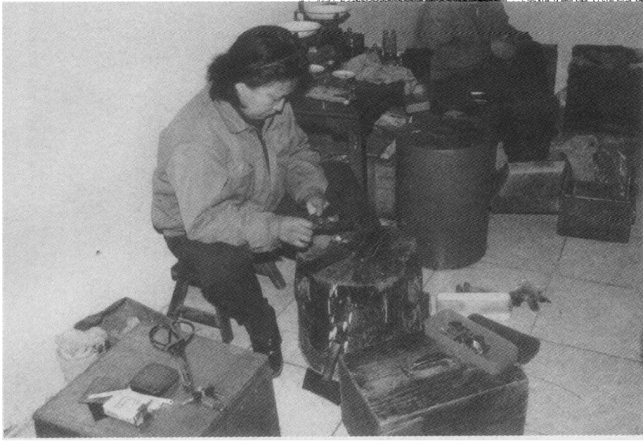
图7 裁金叶:将拍薄的金叶裁剪成方形小片
