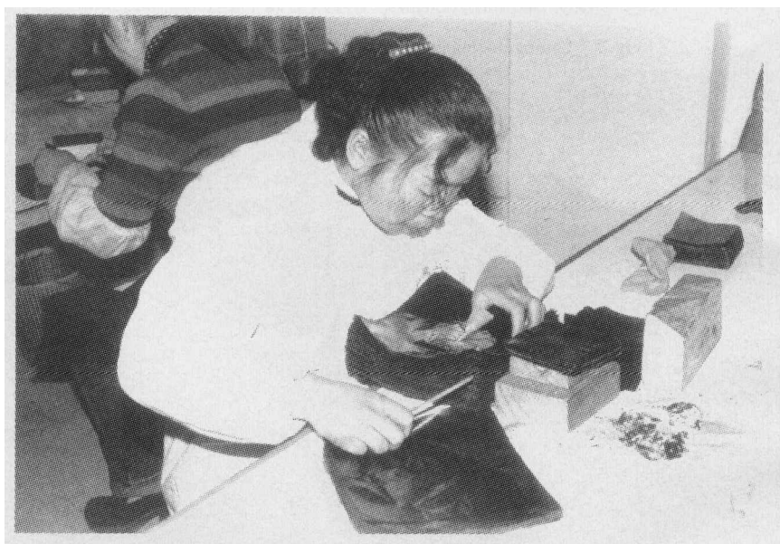
(b) 用竹刀将金开了从 10cm × 10cm 见方的乌金纸内移入 20cm × 20cm 的乌金纸内
