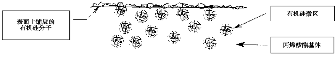
图 1 有机硅微区在丙烯酸酯基体中的分散情况
