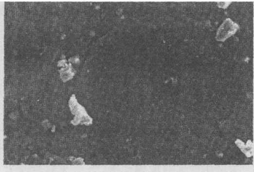
图 6 壁画表面的 PVB 二次电子像 SEM20kV×200
