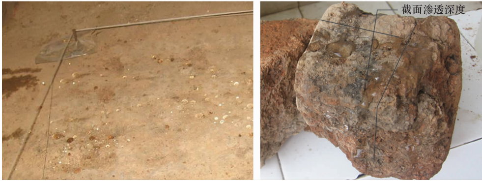
图14 BYG1008 加固后土遗址的防水效果示意图
