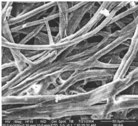
图 7 处理前纸样纤维电镜图
