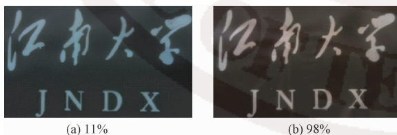
图 8 PAN/CoCl 2 纳米纤维膜在 11% 和 98% 的相对湿度环境下的颜色变化
