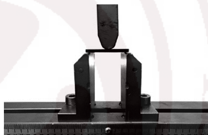
图 4 三维机织角联锁 SiC f /SiC 复合材料三点弯曲试验
