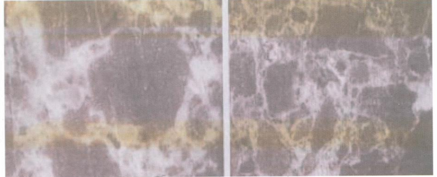
图 28 威字炮台 (左) 和海字炮台 (右) 三合土的显微照片
