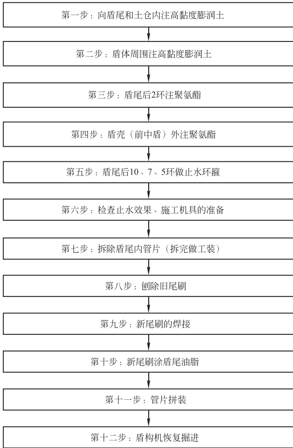
图 5 整个施工工艺流程图
