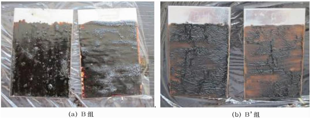
图9 室温下干燥的生漆层(a)和35℃烘箱中干燥的生漆层(b)
