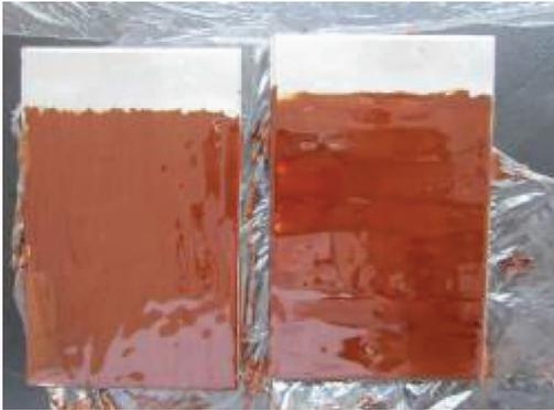
图4 毛刷(左)和刮刀(右)涂抹的漆层
