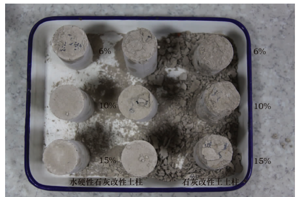
图6 改性土冻融试验照片
