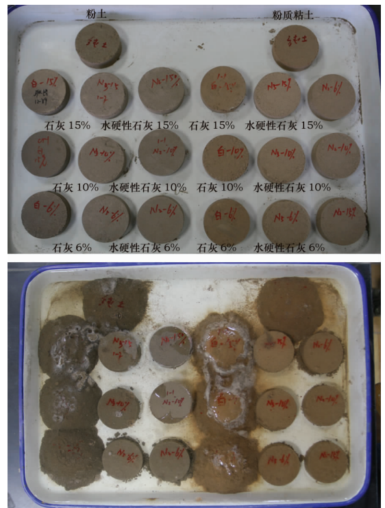
图3 改性土土样养护 28d 的耐崩解性
