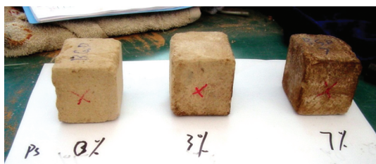
a) 风蚀前不同加固土样
