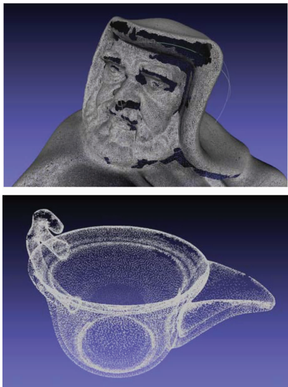
图 2 表面反光造成的扫描数据空洞
