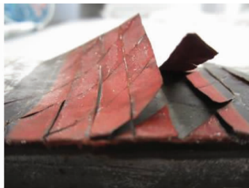
图 1 模拟起翘的漆皮彩绘
