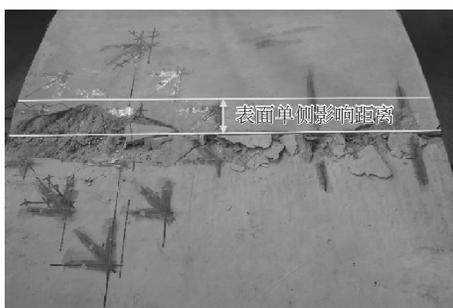
(a) 外弧面接缝混凝土压溃
