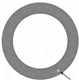
图1 金属夹杂(工业CT图像)
