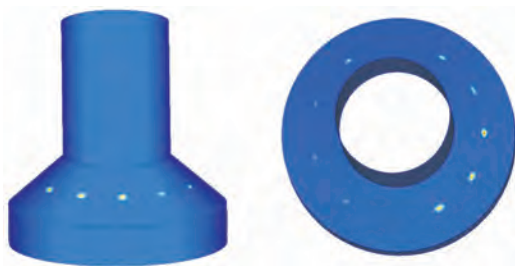
图7 镁合金样品超声波C扫描检测效果
