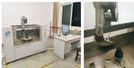
图6 镁合金弹壳超声C扫描自动检测系统
