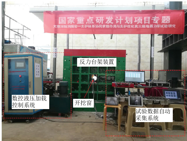
图 3 真三维地质力学模型试验系统
