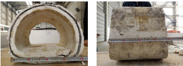
图 21 减震层厚 1cm 隧道结构破坏情况
