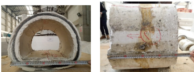
图 22 减震层厚 2cm 隧道结构破坏情况
