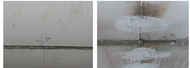
(a) DWF 试件减震墙板相对滑移 (b) ADWF 试件减震层缺陷
