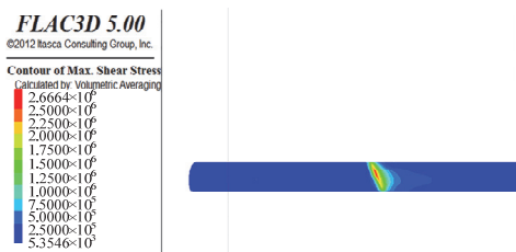
图 26 错动 10cm 二衬剪应力云图
