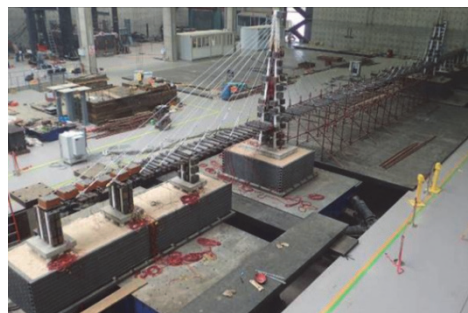
图 3 安装后桩-土-斜拉桥全模型
