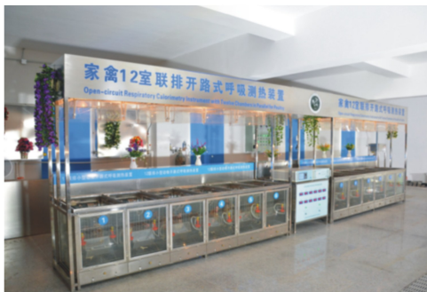
图 1 禽用 12 室并联开放回流式呼吸测热装置
