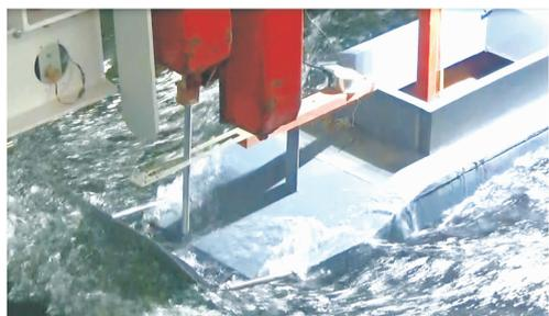
图7 两栖车拖曳试验
