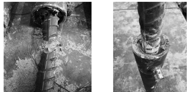
(a) 钢筋拉断破坏
