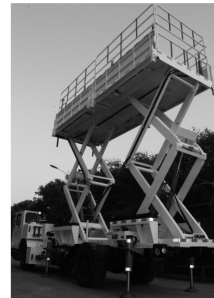
图 4 矿用车载式升降平台样机
