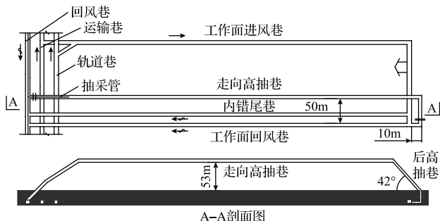
图2 15号煤层回采工作面邻近层瓦斯抽放示意图
