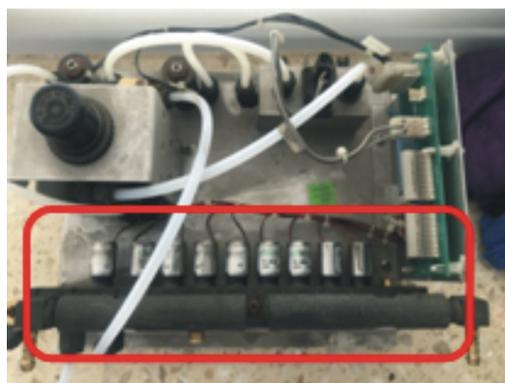
图8 气路箱(矩形框内为ICP气路系统)
