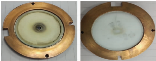
图 4 损坏的微波窗实物图
