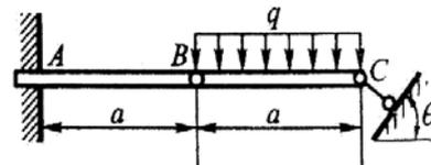
3、求下图示梁支座  $A$ 、 $B$  的约束反力。设力的单位为  $\text{kN}$ ，力偶矩的单位为  $\text{kN}\cdot\text{m}$ ，长度的单位为  $\text{m}$ ，分布载荷集度为  $\text{kN}/\text{m}$ 。
