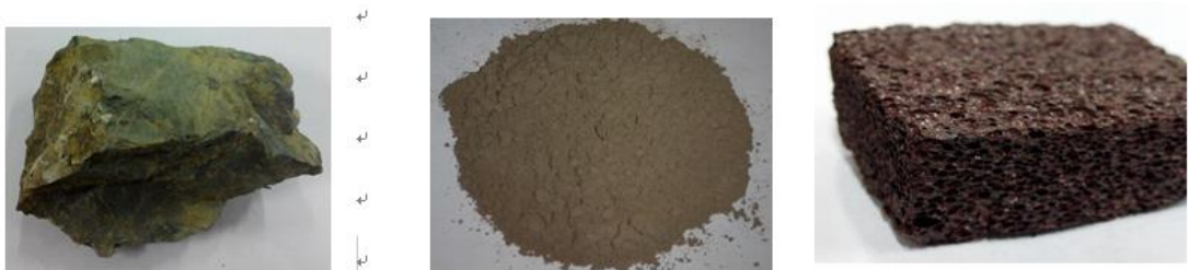
图 16.1 左：頁岩；中：粉煤灰；右：发泡砖
