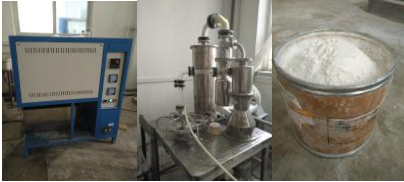
图 13 左: 熔块炉, 中: 气流粉碎机, 右: 产品
