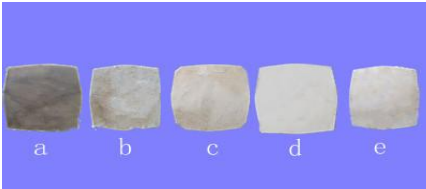
图 31. 2 不同种类主稳定剂复配体系样品的动态稳定作用测试照片，由图 2 可以看出，以稀土稳定剂为主体的稳定剂复配体系（见样品 d）稳定效果好。
