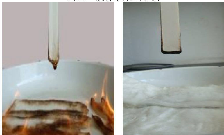
图 30.2 阻燃技术应用前后 TPO 材料样品的阻燃和抗滴落性能对比照片
