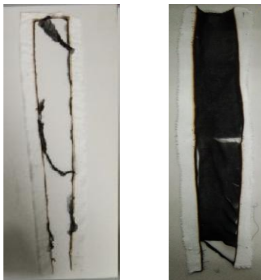
图 5.1 棉织物垂直燃烧测试后残炭图片: (左图) 原棉织物; (右图) 光接枝改性阻燃棉织物
