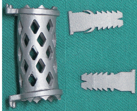
图 2 可固定颈椎钛笼样品图(右侧为插片)
