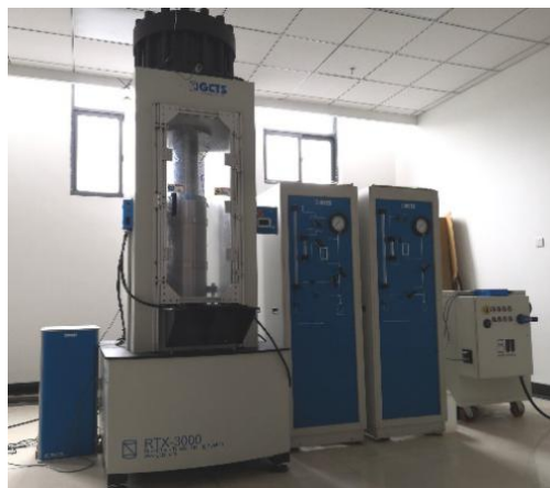
图 3 GCTS RTX - 3000 高温高压岩石三轴试验机 Fig.3 GCTS RTX - 3000 rock triaxial testing machine
