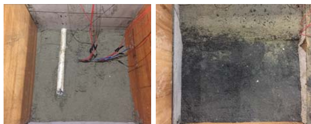
(a) 逆断层底板岩石铺设
