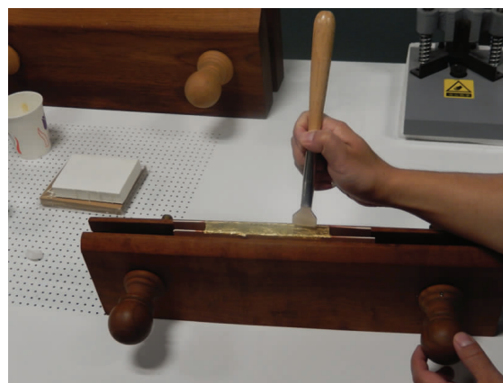
图16 用抛光器直接抛光金箔
