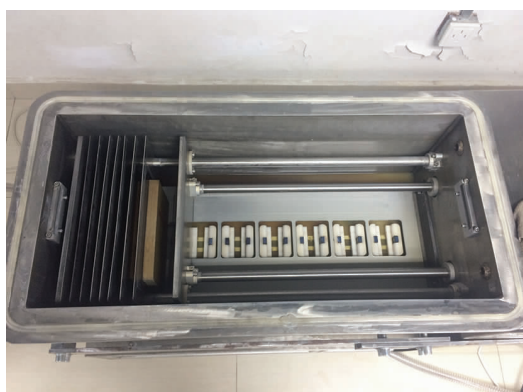
(a) 压差浸泡脱酸系统
