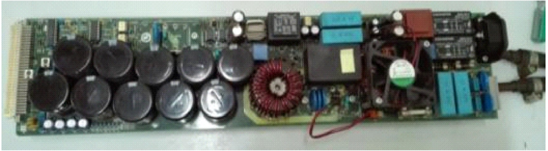
图 5 修复后的 XPSI 电路板
