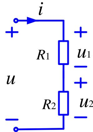
电阻 $R_1$ 、 $R_2$ 消耗的功率为:
