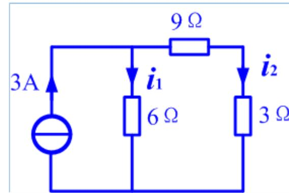
则6Ω电阻消耗的功率  $p_1 = 6i_1^2 = 24\text{W}$ ， 9Ω电阻消耗的功率  $p_2 = 9i_2^2 = 9\text{W}$
