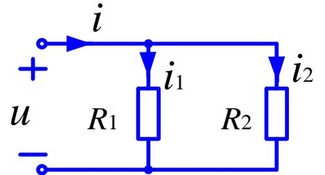
电阻 $R_1$ 、 $R_2$ 消耗的功率为:  $P_{R_1} = G_1 u^2, \quad P_{R_2} = G_2 u^2$
