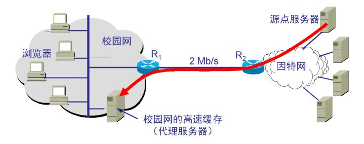
(5) 高速缓存收到此对象后,先复制在其本地存储器 (为今后使用),然后再将该对象放在 HTTP 响 中 应报文中,通过已建立的 TCP 连接,返回给请求该 对象的浏览器。 源点服务器 校园网 浏览器  $\mathbf{R}_1$  $R_2$ 2 Mb/s
