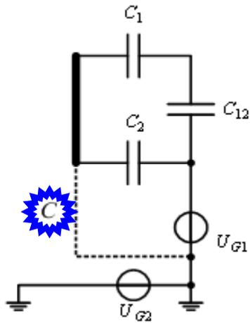
**C**点接地同样存在问题，因为放大器与地之间可能构成骚扰的回路。
