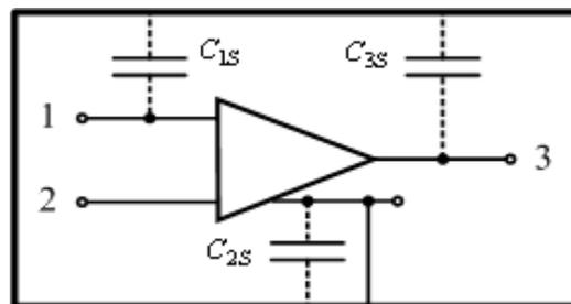
若将放大器公共端与金属机壳相接，当 $C_{2S} = \infty$ 时，反馈到输入端的骚扰电压为0。
