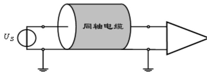
**Note:** 长电缆一般应在每隔 $1/10$ 波长处接地一次。
