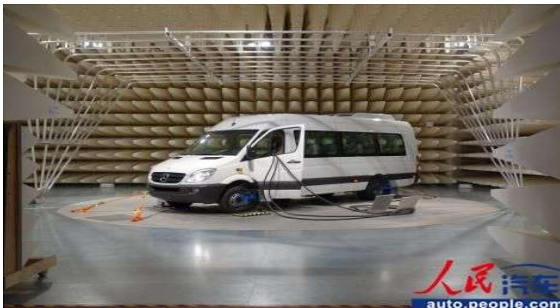
电磁测量暗室
