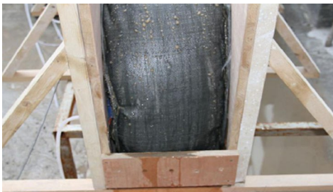
图 12 充灌好的管袋模型
