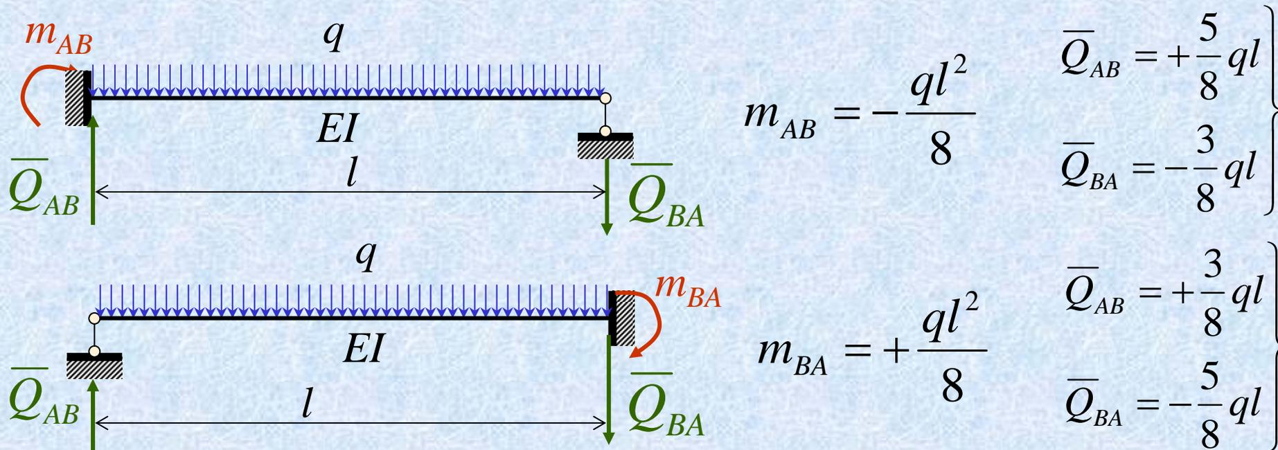
»在已知荷载及杆端位移的共同作用下的杆端力一般公式（转角位移方程）：
