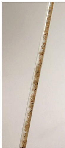
图5 斜向布置虹吸管中水砂两相分布
