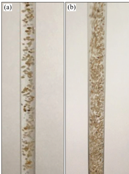
(a) 大粒径砂粒流动; (b) 小粒径砂粒流动
